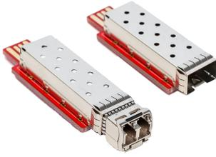
Программатор оптических трансиверов SFPTotal модели Whistle для трансиверов ревизии GT, 1 порт SFP, 1 порт USB, светодиодный индикатор питания
