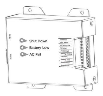
Внешний блок GL-UPS-OL-RCB-Е предназначен для подключения выхода «сухих контактов» к порту RS-232 ИБП для мониторинга состояния источника бесперебойного питания с 3 светодиодами и реле, 5 выходными контактами и 3 общими контактами для контроля состояния и 2 входными контактами в качестве команды отключения ИБП.
