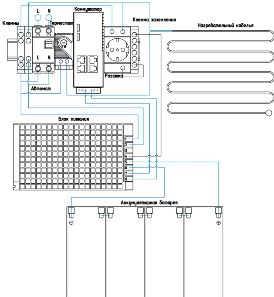
Типовое подключение оборудование внутри телекоммуникационного шкафа.
