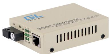
Медиаконвертер преобразует электрический сигнал в оптический и наоборот. Это позволяет увеличить длину участка витой пары до сотен километров. Конвертеры могут использоваться как отдельное устройство или устанавливаться в шасси.
