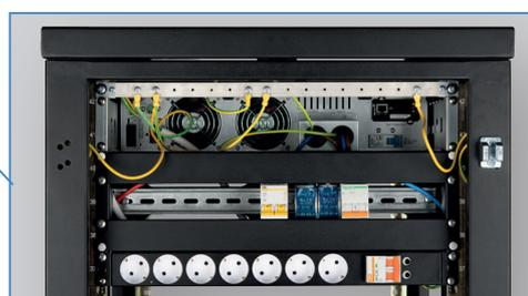
На тыльной стороне: блок розеток с вводным автоматом на 25А, вводной автомат по питанию, защитный автомат на батареи, планка для подводки проводов заземления. На ИБП – клеммный ввод-вывод по питанию, установленная карта SNMP. Также имеется порт управления RS-232.
