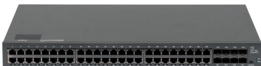
Управляемые коммутаторы L2 — это основные коммутаторы провайдеров и офисных сетей уровня предприятия. Имеют большой спектр управления и защиты информации. На данных коммутаторах строятся сети от 20 и более пользователей. Управляемые коммутаторы используются в тех условиях, где есть необходимость оперативного управления разграниченным доступом.
