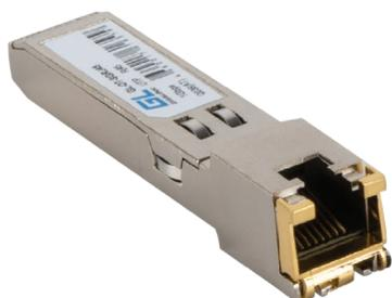
Оптический трансивер (модуль) — используется в сетевом оборудовании для приема и передачи данных между удаленными устройствами — коммутаторами, маршрутизаторами, мультиплексорами и другим телекоммуникационным оборудованием — путем преобразования передаваемого сигнала из оптического в электрический и обратно. Также модули обеспечивают взаимодействие внутреннего интерфейса сетевого устройства с интерфейсом среды передачи, выступая в качестве конвертера интерфейса.
