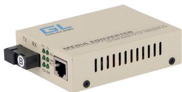
Медиаконвертеры GL-MC-UTPF-SC1F-18SM-1310 и GL-MC-UTPF-SC1F-18SM-1550 устанавливаются парой на разных концах линии связи. Также ответным устройством может быть любой конвертер или SFP-модуль с соответствующими характеристиками. Используют длину волны 1550 нм для приема данных и 1310 нм — для передачи.
