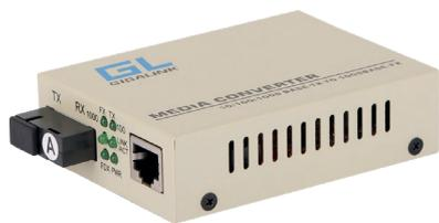
Медиаконвертеры GL-MC-UTPF-SC1G-18SM-1310 и GL-MC-UTPF-SC1G-18SM-1550 устанавливаются парой на разных концах линии связи. Также ответным устройством может быть любой конвертер или SFP-модуль с соответствующими характеристиками. Используют длину волны 1550 нм для приема данных и 1310 нм — для передачи, поддерживает функцию LFP (Link Fault Pass-through), включающую оба порта медиаконвертера только в том случае, если на обоих портах есть сигнал от подключенного устройства.
